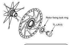
Tightening torque: 40 - 50 N·m {348 - 435 in. lbs}
